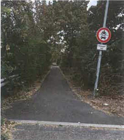
Breiten und Ausbauzustand der vorhandenen Radwegeverbindung, insbesondere der Überleitungsrampe des angesprochenen Geh- und Radweges vor der Einmündung Schwarzenbergweg auf den straßenbegleitenden Geh- und Radweg der Landesstraße entsprechen nicht mehr dem Standard der ERA 2010 (Breite, Höhe der Absturzsicherung).
