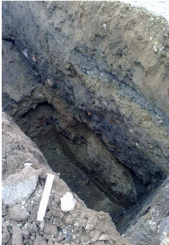
Bild 6: Bodenverhältnisse in Schurf 4
