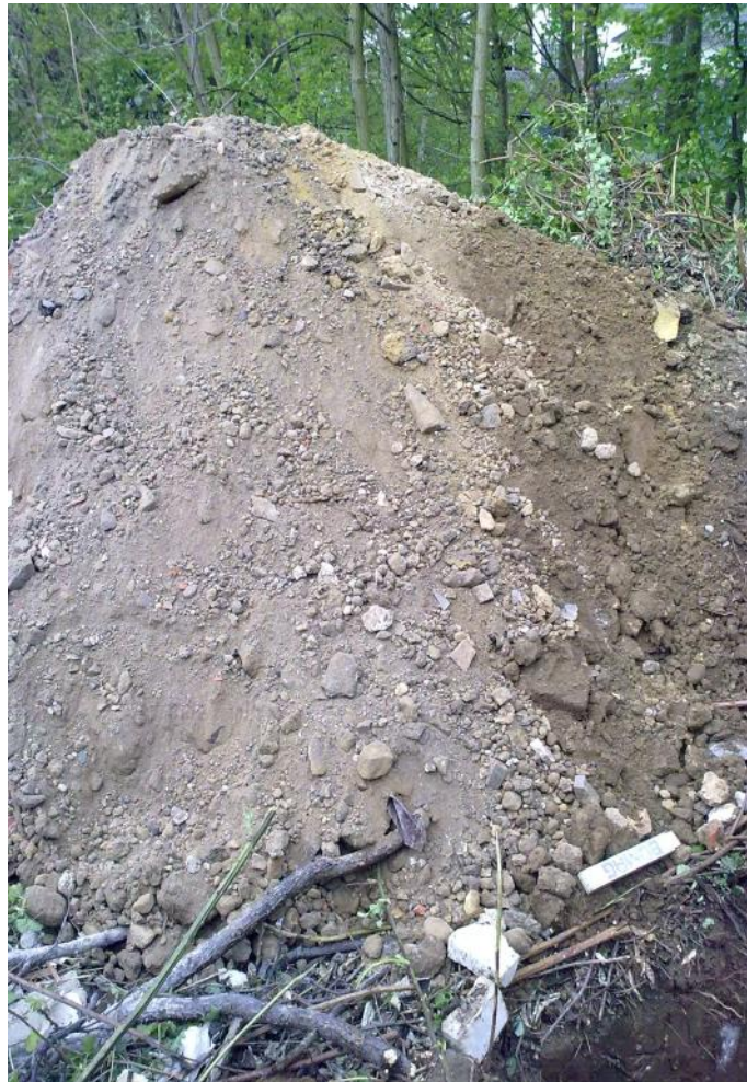
Bild 9: Bodenverhältnisse in Schurf 5 (Haufwerk)
